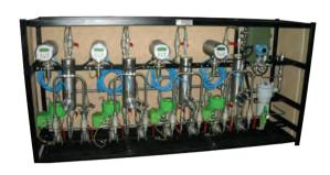
Система состоит из двух, трех или четырех каналов ввода ингибитора, работающих независимо друг от друга от общей входной магистрали, на которой расположен фильтр тонкой очистки ингибитора. По требованию заказчика в системе может устанавливаться дополнительная фильтрующая линия для безостановочной работы на время техобслуживания (замены фильтрующего элемента) основного фильтра.
