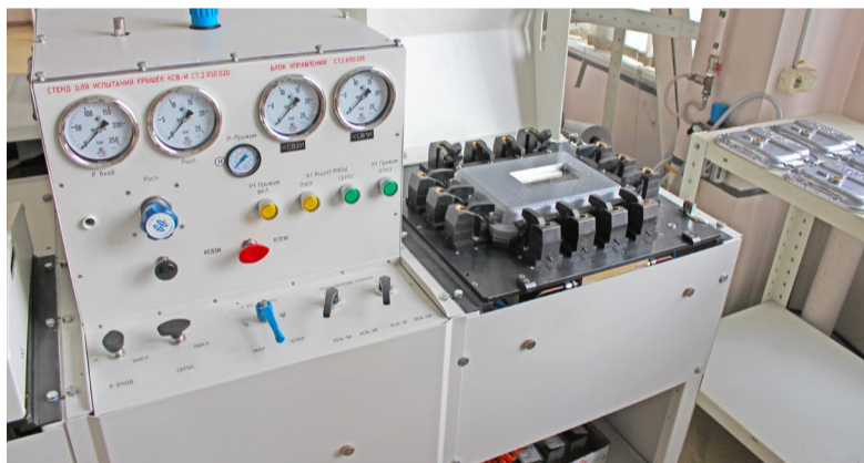
Модифицированная коробка KV3-3T на испытательном стенде
